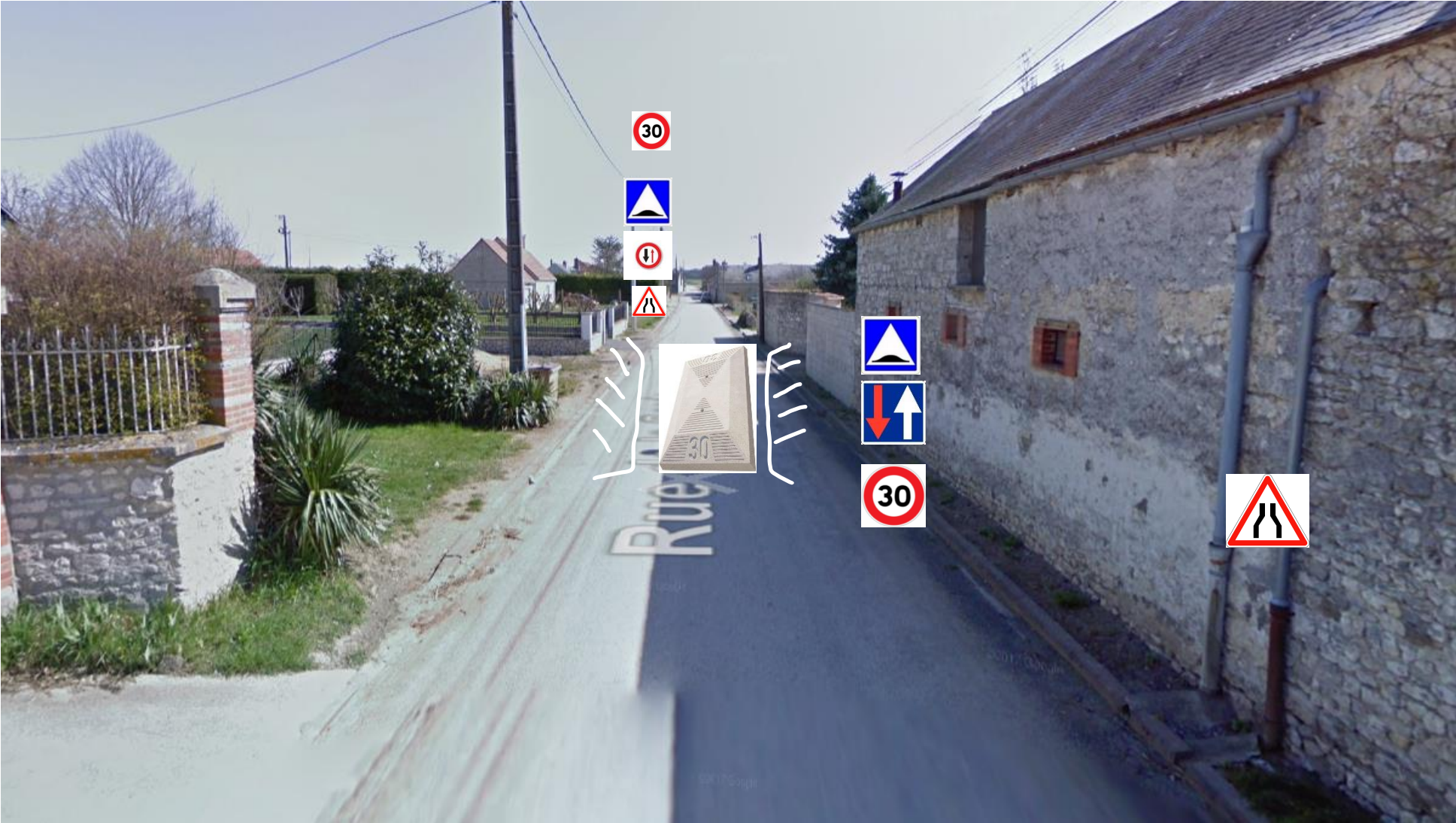
Rue de la Garde, Coussin Berlinois en Préfac béton, avec peinture pour un rétrécissement visuel,
